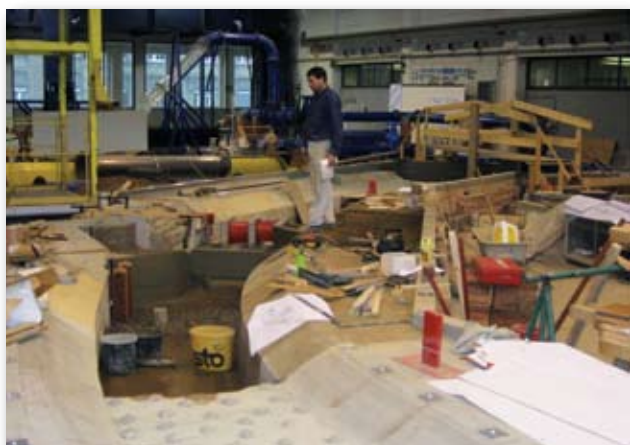
Hidravlični model rečne hidroelektrarne, pri katerem so sodelovali udeleženci namestitve.
