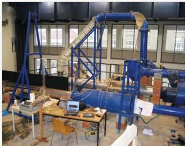
Hidravlični model tlačnega razvoda črpalne hidroelektrarne, pri katerem so sodelovali udeleženci namestitve.
